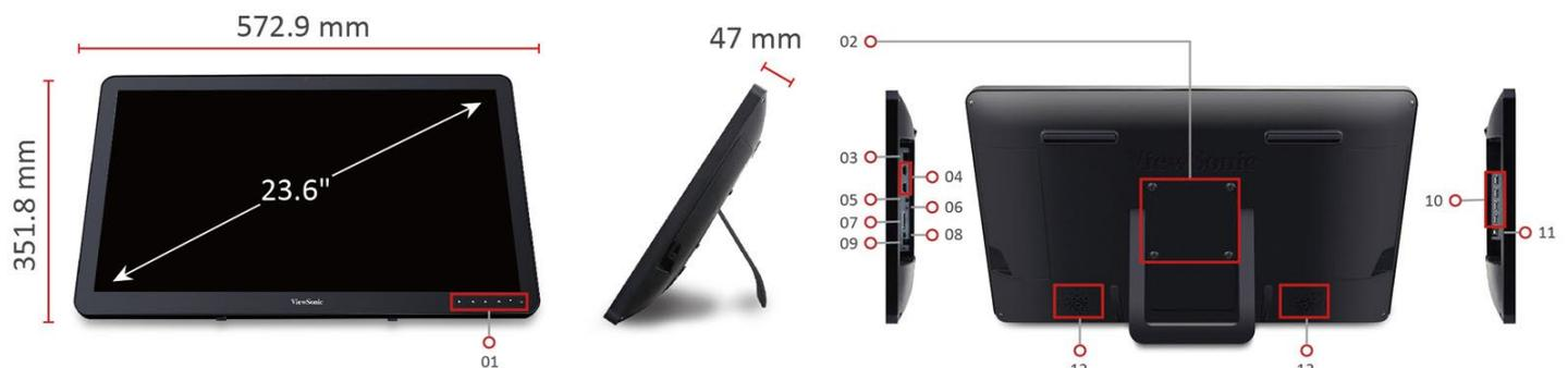
**1** Bedienelemente**2** VESA Montagemöglichkeit**3** LAN (RJ45)**4** HDMI/MHL/ In/Out**5** Audio In**6** Kopfhörer**7** SD Karten Steckplatz**8** Mini USB**9** DC in (Netzteil)**10** USB 2.0 (x4)**11** USB Typ B**12** Lautsprecher
